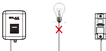
Nieprawidłowe podłączenie pomiędzy odbiornikami
