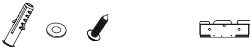
Kołki rozporowe, uszczelka, śruby samogwintujące
